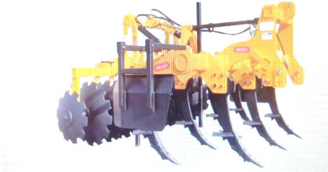
1-rasm. Xorijiy kompaniyalar tomonidan ishlab chiqarayotgan zamonaviy, kombinatsiyalashgan chuqur yumshatkich namunasi
