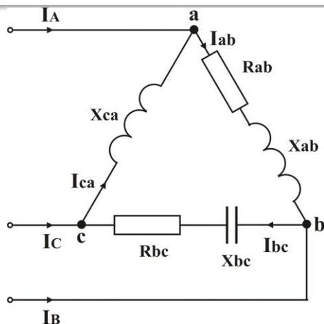
При соединении нагрузки треугольником каждая фаза нагрузки включена между двумя линейными проводами, следовательно, фазные напряжения равны соответствующим линейным
