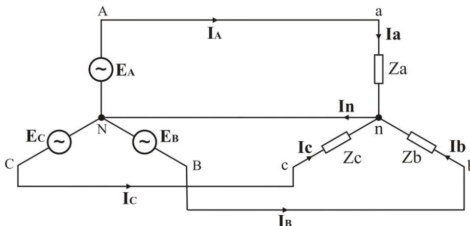
Статор трехфазного генератора имеет три обмотки с одинаковым числом витков, соединенные звездой. Обмотки смещены в пространстве на  $120^\circ$ . При вращении якоря, создающего постоянное магнитное поле, в обмотках статора индуцируются три ЭДС ( $\vec{E}_A, \vec{E}_B, \vec{E}_C$ ), одинаковые по величине, но сдвинутые по фазе на  $120^\circ$ .
