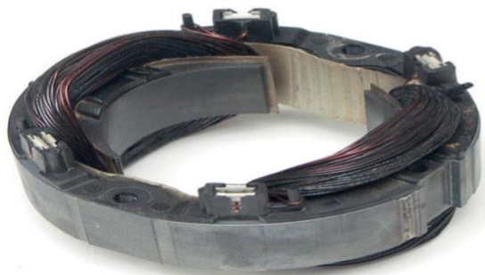
Рисунок 1. Повреждение обмотки статора.
