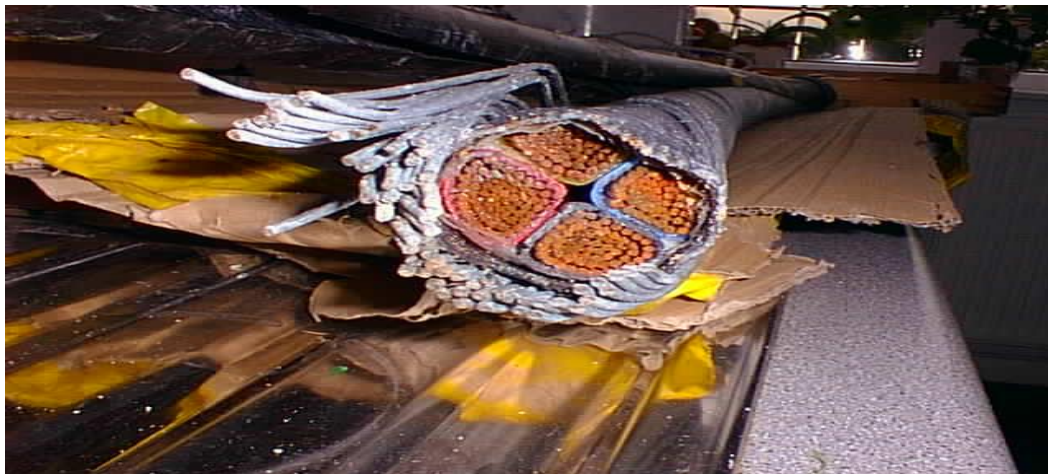
Рисунок-1. Коррозия металлической оболочки кабеля
