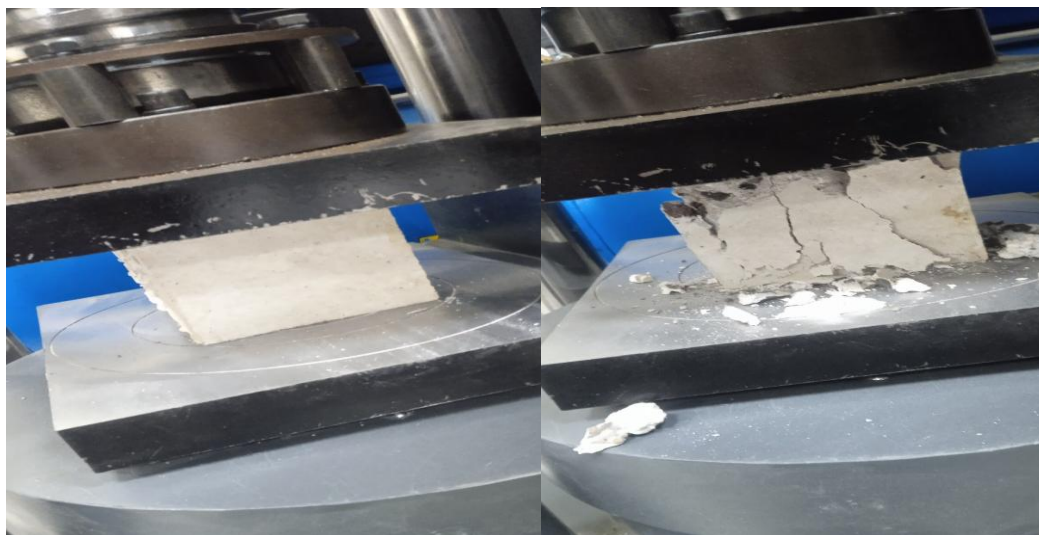
2-rasm. Tajriba sinov jarayoni. Gipslikeramzitbeton namunalarini siqilishga bo'lgan mustahkamligini aniqlash jarayoni
