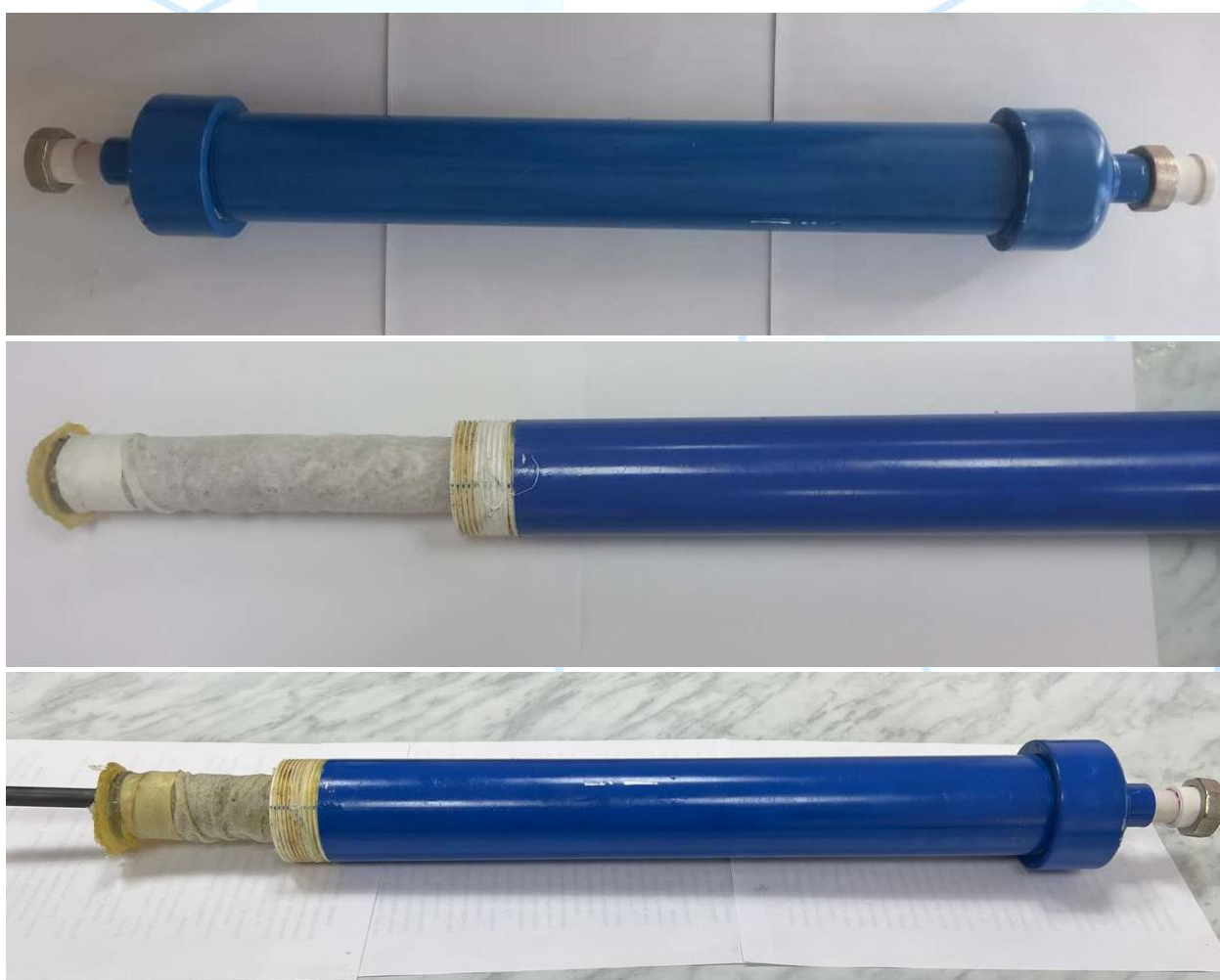
2-rasm. Magnitli moy filtrining umumiy ko‘rinishi
