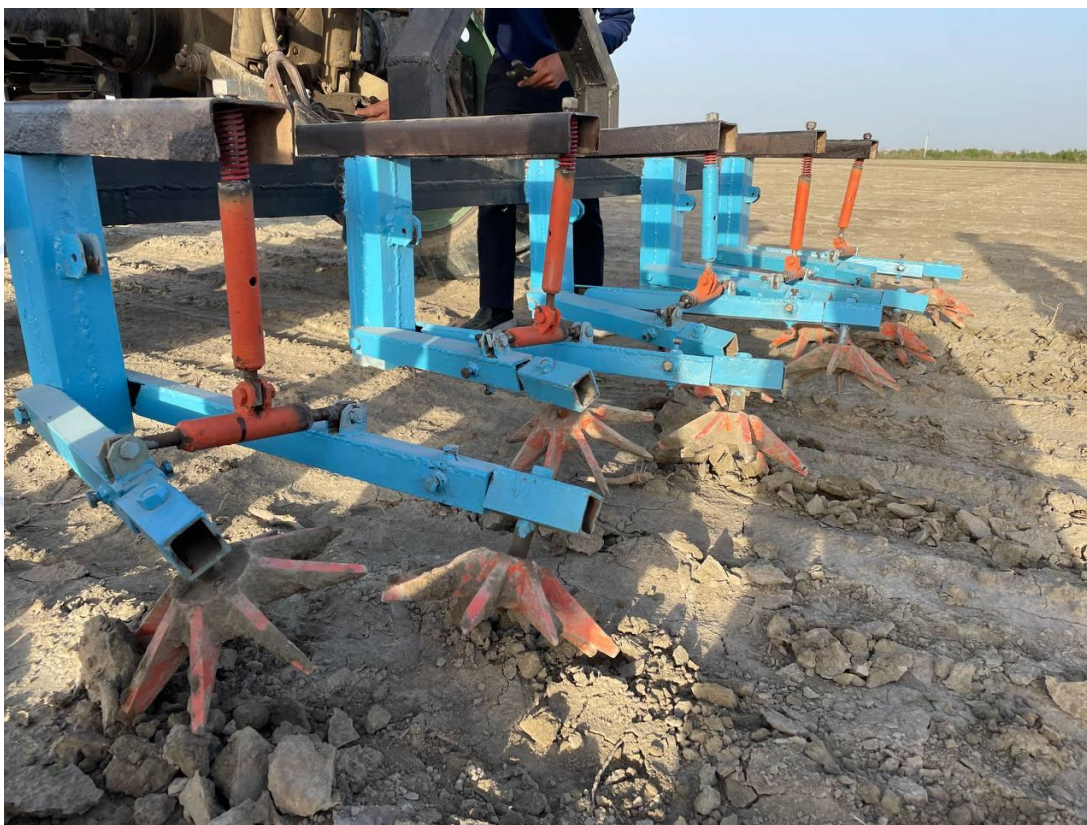
5-расм. Қатқалоқни юмшатиш қурилмаси ишчи органларнинг иш жараёнида кўриниши.
