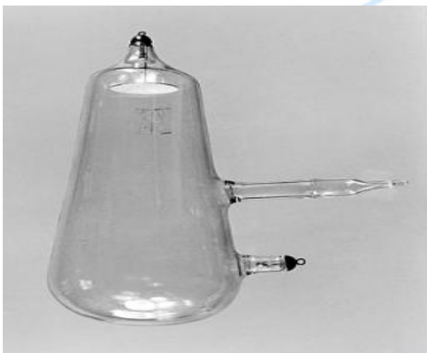
Crookes trubkasi misoli, rentgen nurlarini chiqaradigan tushirish trubasining bir turi
