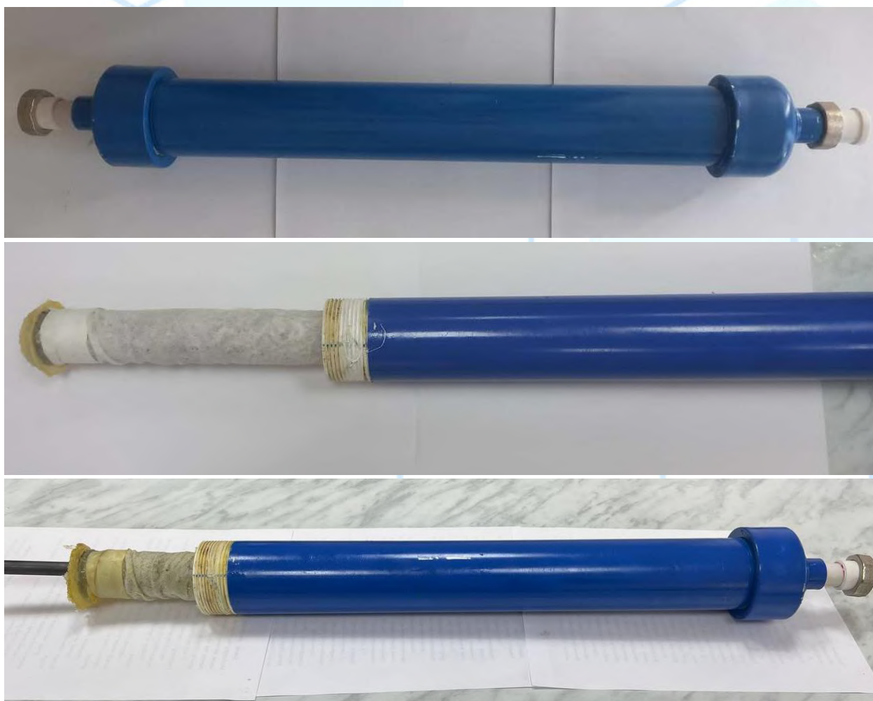
2-rasm. Magnitli moy filtrining umumiy ko‘rinishi
