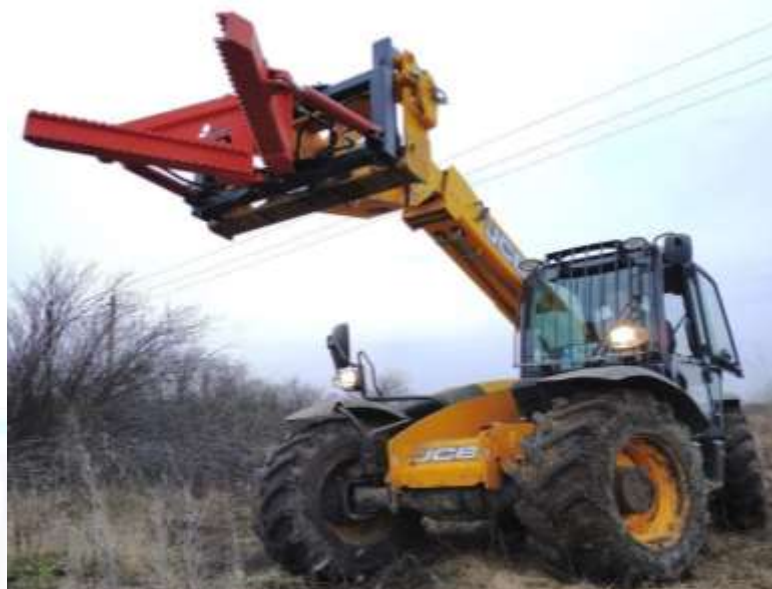
Рис. 3. Машина БЛ-270-01 Кундакова
