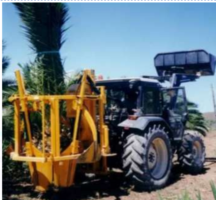
Рис. 1. Машина для выкапывания и пересадки деревьев Extir Plants B900.
