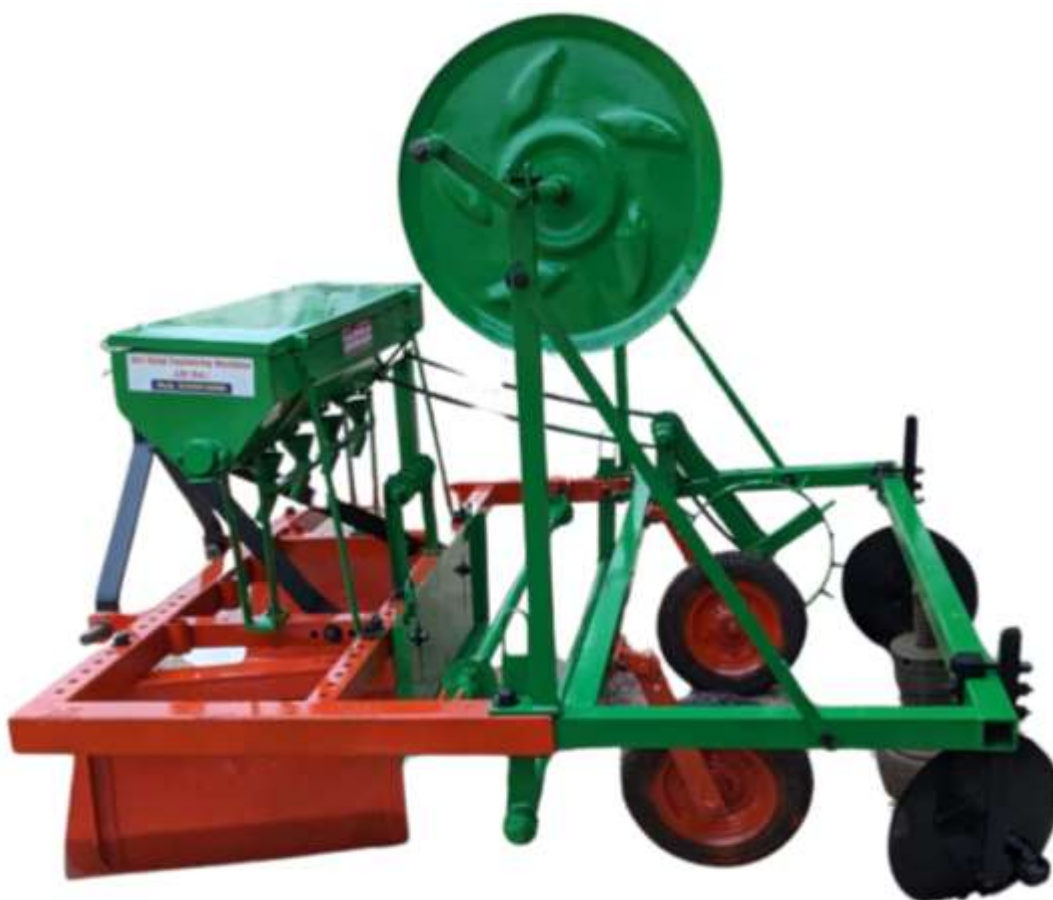
5 – rasm. Tomchilab sug'orish shlanglarini va plastik plyonkalarni yotqizish mashinaning umumiy ko'rinishi
