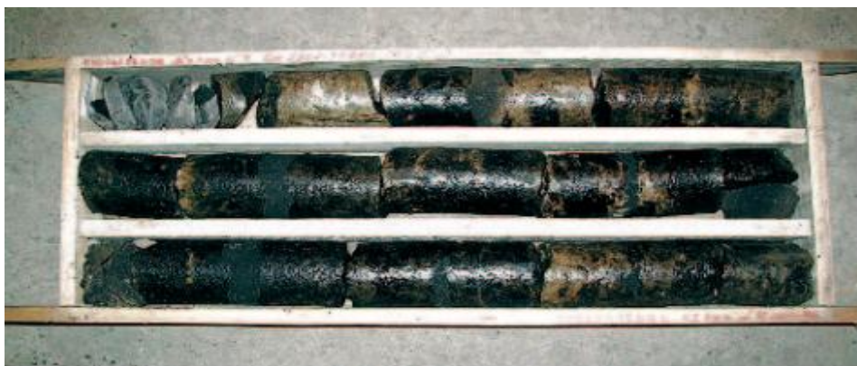
Рис. 4. Запарафинированный керн, отобранный из скважины, 100%-ый вынос керна.
